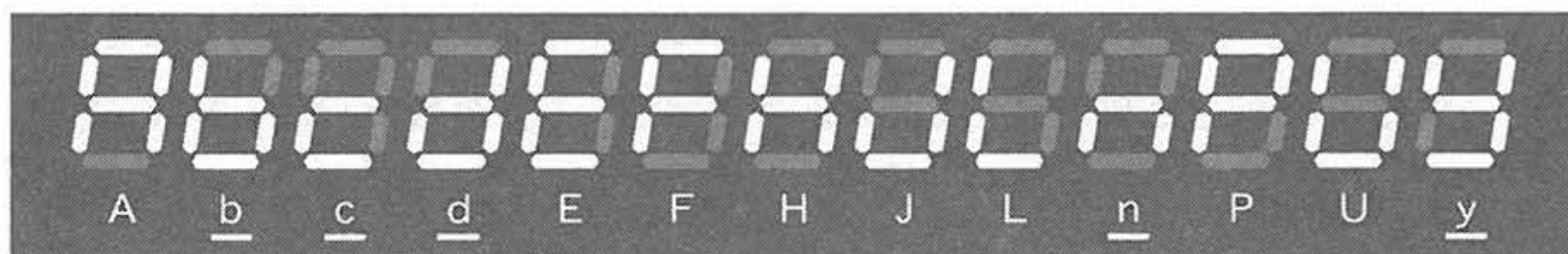
図 3 7セグメント LED で表示したアルファベット(下線は小文字を示す)
